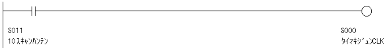
図2.1 タイマ基準クロックとして スキャンタイムを使用した例
