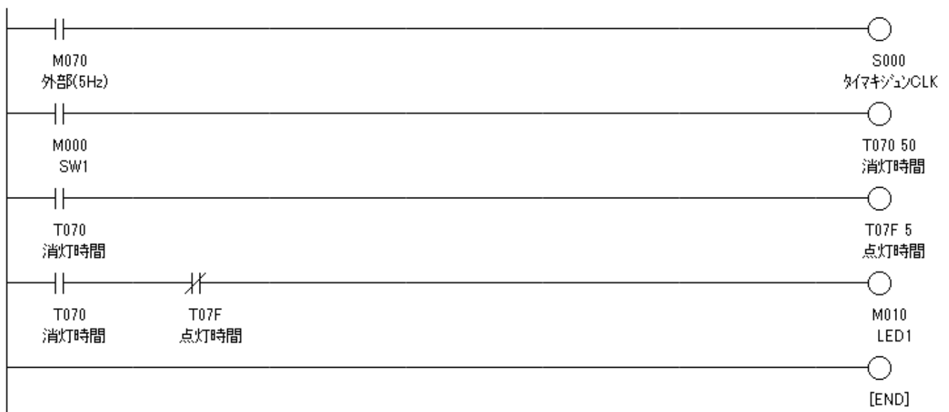
図2.3 作成したラダー図
