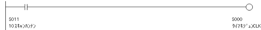
図2. 6 ラダー図でタイムベースを与える方法
